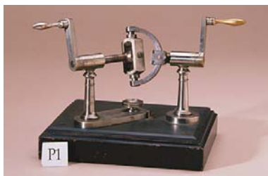
Sl.5. Univerzalni zglob (Hukov ili Kardanov). Model No P1, Voigt katalog, Cornell Reuleaux kolekcija
