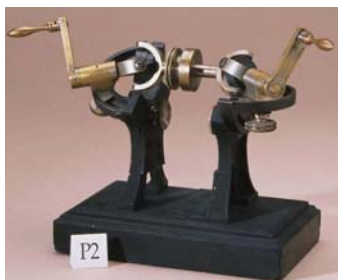
Sl.6. Model udvojenog kardanskog zgloba, Model No.P2, Voigt katalog, Cornell Reuleaux kolekcija [23].
